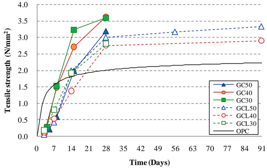
**Fig. 2. Tensile strength**
