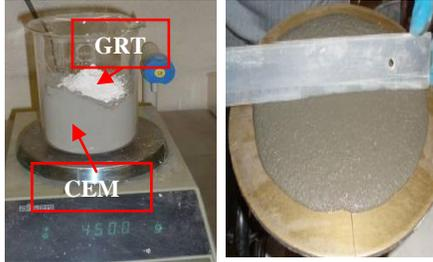
**Fig. 11. Flow test**
