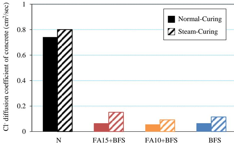
**Fig. 5 Cl<sup>-</sup> diffusion coefficient of concrete**
